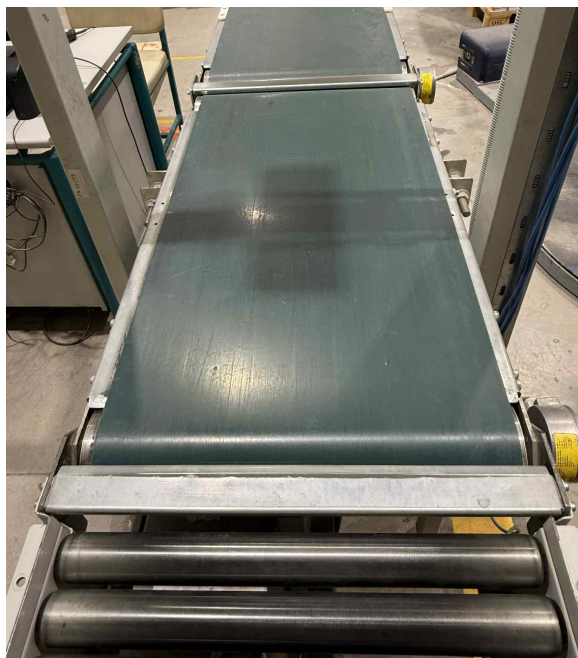
Εικόνα 2: Επιταχυντής ενός σταδίου ταινιοδρόμου
