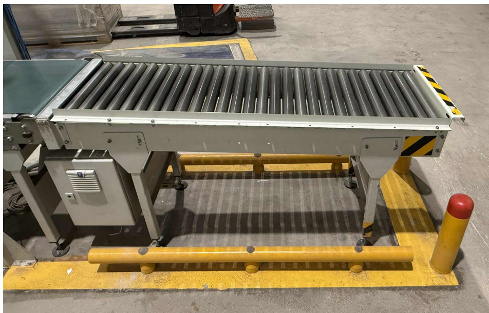
Εικόνα 3: Βαρυτικός ραουλόδρομος εξόδου
